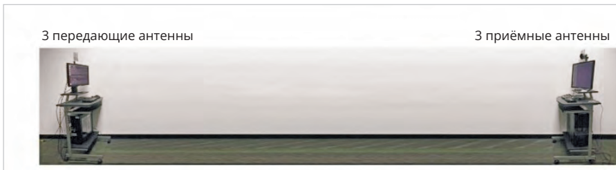
Рис. 4. Иллюстрация оценки позы объекта по отражённому сигналу Wi-Fi в сценариях с окклюзией. Стандарт антенн 6Dbi PR-SMA 2,4 ГГц
