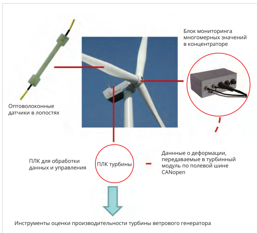
Рис. 2. Тензодатчики, встроенные в лопасти ветрогенератора
