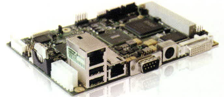
Рис. 6. Одноплатный 3,5-дюймовый компьютер Kontron JRexplus
