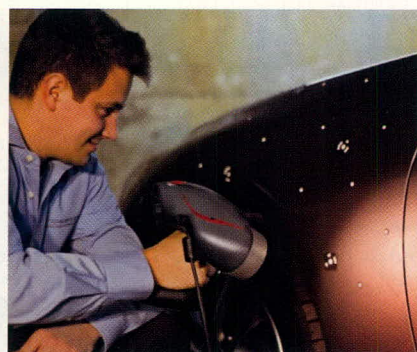
Рис. 2. «Привязка» сканера к объекту с помощью меток
