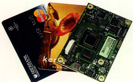
Рис. 2. Габариты модулей nanoETXexpress примерно соответствуют размерам стандартной кредитной карточки
