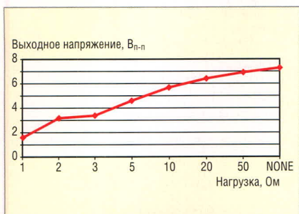
Рис. 7. Нагрузочная характеристика усилителя SSC P111
