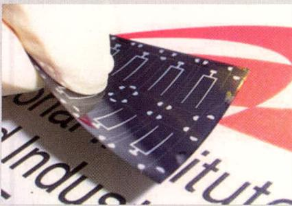
AIST использует в производстве батареи три вида подложек – керамическую, прозрачную пластиковую плёнку производства Teijin и титановую фольгу с грубой поверхностью. Эффективность в 17,7% была достигнута с керамической подложкой. Эффективность при использовании пластиковой плёнки и титановой фольги составляет 14,7 и 17,4%.
