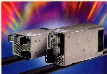
Модели HWS300P и HWS600P охватывают ряд выходных напряжений 24, 36 и 48 В и работают от сети переменного напряжения с предельными значениями 85...265 В/47...63 Гц. Изделия характеризуются отличными показателями качества и габаритно-массовыми характеристиками. Размеры 300-ваттной модели 61 × 82 × 165 мм и 100 × 82 × 165 мм для 600-ваттной модели. Диапазон рабочих температур –10...+70°C.
