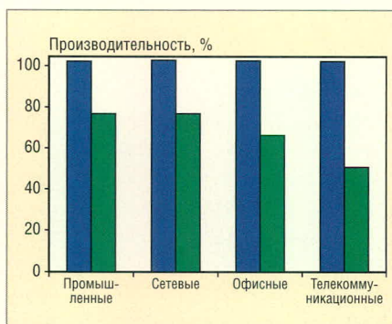
Рис. 2. Сравнение объёма кода стандартных ARM-процессоров ARM7TDMI-S (ARM) и процессоров Cortex-M3 (Thumb-2) для типовых приложений
