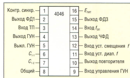
Рис. 5. Нумерация выводов микросхемы CD4046
