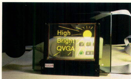
Рис. 8. Внешний вид прозрачного электролюминесцентного дисплея QVGA
