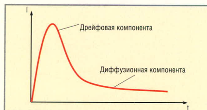
Рис. 3. Типовая временная зависимость импульса ионизационной реакции тока в полупроводниковой структуре ИС
