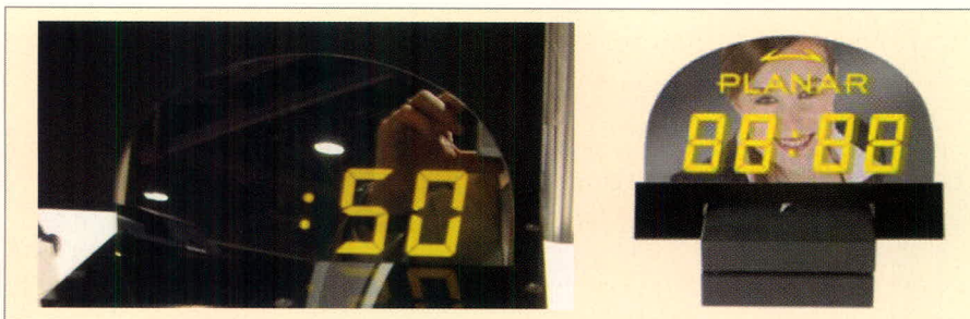
Рис. 12. Прозрачный TFEL-дисплей с зеркалом в передней поверхности обеспечивает новые возможности и эффекты
