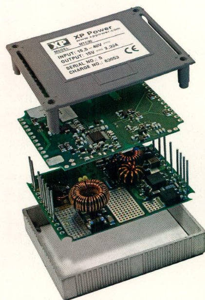
Рис. 1. Типичный COTS-преобразователь (модуль серии МТС компании XP Power), выполненный с использованием «этажерки» из печатных плат
