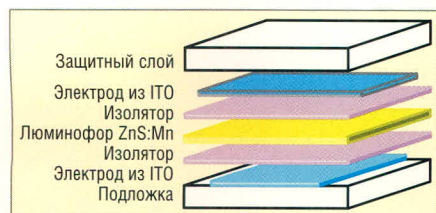
Рис. 7. Схема поперечного сечения прозрачной тонкопленочной электролюминесценции
