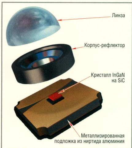
Рис. 5. Конструкция СЛ компаний Cree
