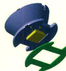
Рис. 13. Принцип крепления линзы на плату
