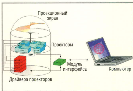
Рис. 3. Структура портативной 3D-дисплейной системы Felix
