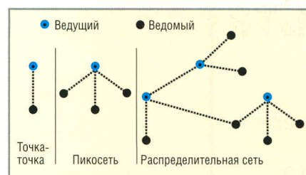
Рис. 2. Варианты топологии сетей Bluetooth
