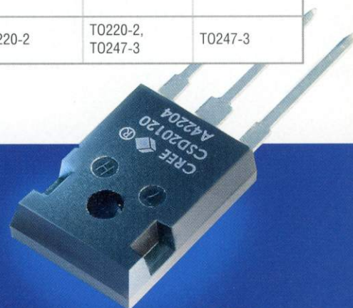
Высоковольтные 300...1200 В ZeroRecovery™ диоды Шоттки на основе карбида кремния компании Cree
