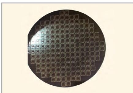
Рис. 6. Мультизаготовка из кремния диаметром 100 мм со встроенными «корпусами» СБИС СпК размером 6 × 6 мм
