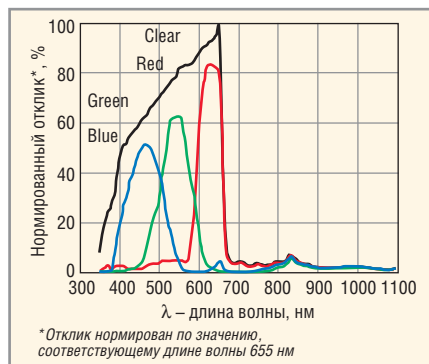
Рис. 2. Частотная характеристика датчика TCS3414CS
