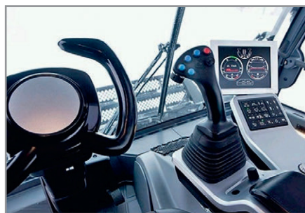
Рис. 1. Клавиатура ЗК, встроенная в панель управления снегоуборочной машины
