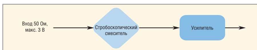
Рис. 9. Архитектура стробоскопического осциллографа
