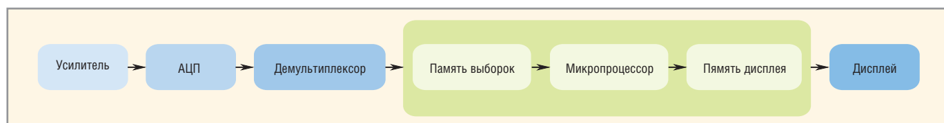
Рис. 5. Архитектура последовательной обработки цифрового запоминающего осциллографа
