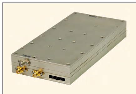
Рис. 1. Внешний вид синтезатора частот UNO-10M, габаритные размеры 87,5 × 185 × 26,8 мм
