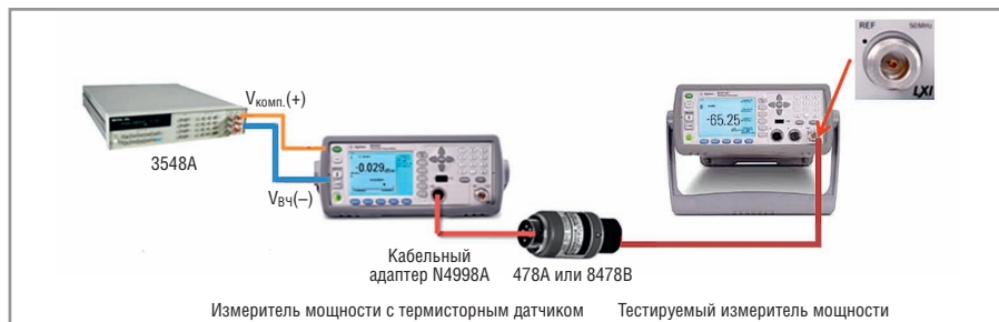
Рис. 2. Типовая схема измерений эталонной мощности 1 мВт 50 МГц [2]
