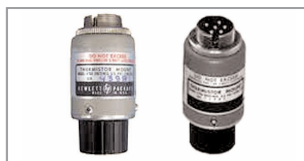
Рис. 4. Специальные термисторные головки, обладающие низким КСВ на частоте 50 МГц
